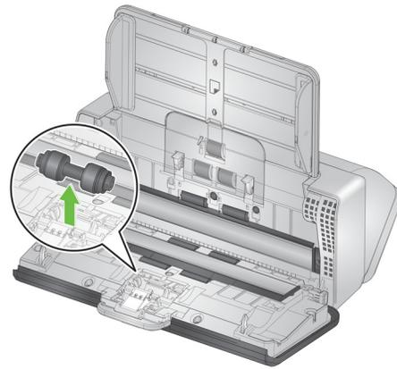
4. Setzen Sie die neue Trennrolle ein, indem Sie die Lasche an der Aussparung ausrichten und die Rolle einrasten lassen.
