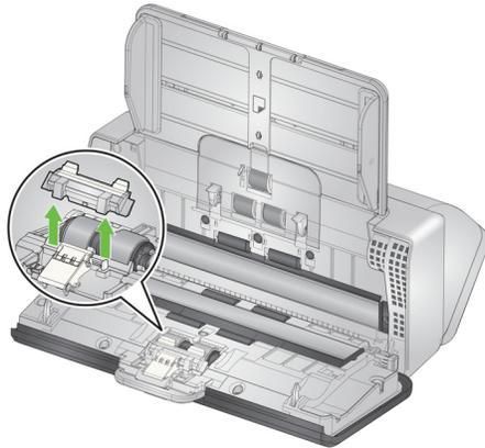
3. Greifen Sie die Separator-Rolle und ziehen Sie sie gerade heraus. Entsorgen Sie sie.
