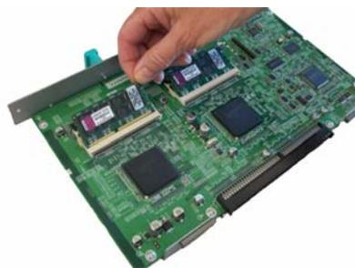
6. Insérez le module jusqu'à ce qu'il s'enclenche et que les onglets blancs situés sur le connecteur de module se referment autour du module SODIMM. Vérifiez que l'encoche sur le module SODIMM se situe du côté gauche lorsque vous insérez le module SODIMM. Si l'encoche n'est pas dans cette position, il est impossible d'insérer le module SODIMM correctement.
