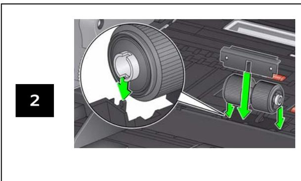
Consultare il Manuale per l'utente per le procedure di sostituzione del modulo di alimentazione e il rullo di trasporto anteriore.
