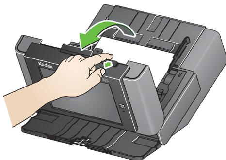
2. 除去所有卡住的文档，关闭 Scan Station 护盖，恢复扫描。
