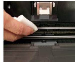
2. Wischen Sie die NFR-Rollen von einer zur anderen Seite ab. Drehen Sie dabei die NFR-Rollen, um ihre gesamte Oberfläche zu reinigen. Bestellen Sie zur leichteren Reinigung *Kodak i1120 Scanner-Reinigungstupfer*.
