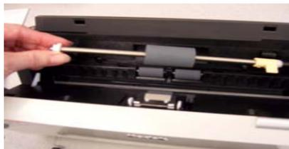
4. Installieren Sie die neue Einzugsrolleneinheit, indem Sie das Schaftende der Einheit ausrichten.
