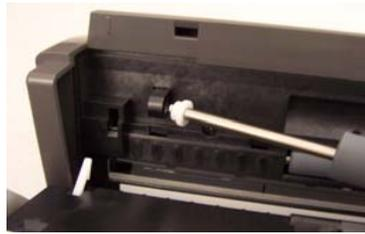
5. Lassen Sie die Einzugsrolleneinheit bei nach oben gedrehtem orangefarbenem Hebel einrasten.
