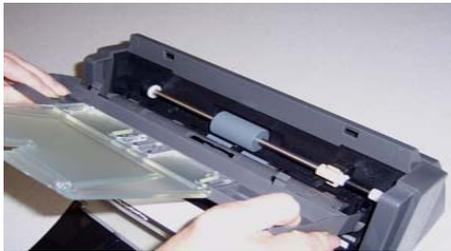
2. Drehen Sie den orangefarbenen Hebel nach oben, um die Einzugsrolleneinheit zu lösen.
