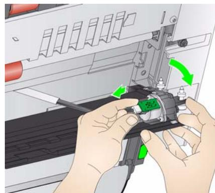
6. Installez le fond retournable en connectant le câble et en alignant les ressorts à son extrémité. Remettez les vis en place et resserrez-les. *Ne serrez pas trop.*
