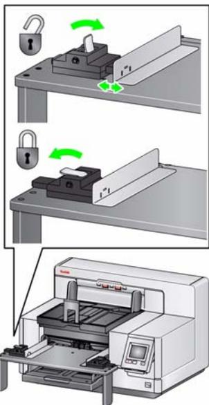
8. Réglez le guide latéral sur la position souhaitée en le faisant glisser pour l'adapter à la largeur des documents à numériser.
