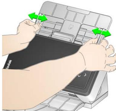
3. Si es necesario, ajuste la bandeja de entrada y salida según sus necesidades de digitalización. La bandeja de salida puede extenderse para ajustarse a documentos de hasta 35,56 cm (14 pulgadas) de longitud. Dispone de un tope final para ajustar el apilado de documentos. Levante este tope final según sea necesario para la digitalización de documentos de tamaño no superior a A4 (11,7 pulgadas).
