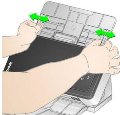
3. Si nécessaire, vous pouvez régler les plateaux d'entrée et de sortie en fonction de vos besoins de numérisation. Le plateau de sortie peut être rallongé pour recevoir des documents jusqu'à 35,56 cm. Une butée permet de régler l'empilement des documents. Levez cette butée selon les besoins pour numériser des documents jusqu'au format A4.
