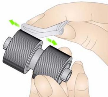
7. Ispezionare le gomme. Se le gomme del modulo separatore mostrano segni di usura o di danno, sostituirle oppure sostituire il rullo separatore. Consultare la sezione "Procedure di sostituzione" più avanti in questo stesso capitolo.
