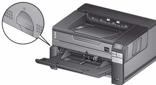
4. スキャンする原稿を入力トレイにセットします。片面の原稿をスキャンする場合は、必ずスキャンする面を上に出します。
