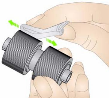
7. タイヤを点検します。タイヤに消耗または損傷している兆候がある場合は、セパレーションローラを交換します。後述の「交換手順」を参照してください。
